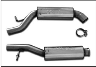
**MEC Design Bi-Turbo Vorschalldämpfer (VSD) für Auspuffanlage** für W220 S600 Bi-Turbo (Facelift ab Bj 2003), (nur in Verbindung mit MEC Design Endschalldämpfer Best. Nr.: 220+215/AA-ESD-H) Edelstahl, rechts + links, geprägtem MEC Design Logo auf der Unterseite der Töpfe, bestehend aus 2 Vorschalldämpfer
