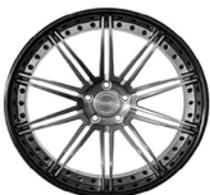
MEC Design meCCon Series, CCd105 Alu-Felgen, 3tlg. geschmiedet, Vorderachse 9Jx20 / Hinterachse 12,5Jx21, Farben/Finish nach Wunsch (Carbon Außenbetten mit Aufpreis); mögliche Reifen VA 235/35 ZR 20 sowie HA 355/25 ZR 21; Montagekit ist im Lieferumfang enthalten; bitte RDK berücksichtigen (nicht im Lieferumfang).
