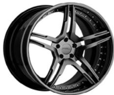
MEC Design meCCon Series, CCd5 Alu-Felgen, 3tlg. geschmiedet, Vorderachse 9,5Jx21 / Hinterachse 12,5Jx22, Farben/Finish nach Wunsch (Carbon Außenbetten mit Aufpreis); mögliche Reifen VA 255/30 ZR 21 sowie HA 335/25 ZR 22; Montagekit ist im Lieferumfang enthalten; bitte RDK berücksichtigen (nicht im Lieferumfang).
