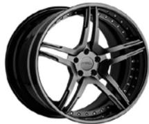
MEC Design meCCon Series, CCd5 Alu-Felgen, 3tlg. geschmiedet, Vorderachse 10Jx21 / Hinterachse 12Jx21, Farben/Finish nach Wunsch (Carbon Außenbetten mit Aufpreis); mögliche Reifen VA 255/30 ZR 21 sowie HA 305/25 ZR 21; Montagekit ist im Lieferumfang enthalten; bitte RDK berücksichtigen (nicht im Lieferumfang).
