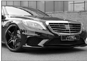
MEC Design meCCon Series, CCd5 Alu-Felgen, 3tlg. geschmiedet, Vorderachse 9,5Jx21 / Hinterachse 10,5Jx21, Farben/Finish nach Wunsch (Carbon Außenbetten mit Aufpreis); mögliche Reifen VA 255/30 ZR 21 sowie HA 295/25 ZR 21; Montagekit ist im Lieferumfang enthalten; bitte RDK berücksichtigen (nicht im Lieferumfang).
