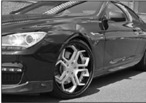
MEC Design meCCon Series, CC5 Alu-Felgen, 3tlg. geschmiedet, Vorderachse 9,5Jx21 / Hinterachse 10,5Jx21, Farben/Finish nach Wunsch (Carbon Außenbetten mit Aufpreis); mögliche Reifen VA 255/30 ZR 21 sowie HA 295/25 ZR 21; Montagekit ist im Lieferumfang enthalten; bitte RDK berücksichtigen (nicht im Lieferumfang).
