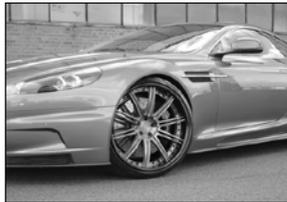
MEC Design meCCon Series, CCd10 Alu-Felgen, 3tlg. geschmiedet, Vorderachse 9,5Jx21 / Hinterachse 10,5Jx21, Farben/Finish nach Wunsch (Carbon Außenbetten mit Aufpreis); mögliche Reifen VA 255/30 ZR 21 sowie HA 295/25 ZR 21; Montagekit ist im Lieferumfang enthalten; bitte RDK berücksichtigen (nicht im Lieferumfang).
