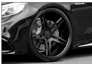
MEC Design meCCon Series, CCd5 Alu-Felgen, 3tlg. geschmiedet, Vorderachse 9,5Jx22 / Hinterachse 11Jx22, Farben/Finish nach Wunsch (Carbon Außenbetten mit Aufpreis); mögliche Reifen VA 265/30 ZR 22 sowie HA 305/25 oder 315/25 ZR 22; Montagekit ist im Lieferumfang enthalten; bitte RDK berücksichtigen (nicht im Lieferumfang).
