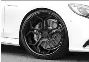
MEC Design meCCon Series, CC5 Alu-Felgen, 3tlg. geschmiedet, Vorderachse 9,5Jx22 / Hinterachse 11Jx22, Farben/Finish nach Wunsch (Carbon Außenbetten mit Aufpreis); mögliche Reifen VA 265/30 ZR 22 sowie HA 305/25 oder 315/25 ZR 22; Montagekit ist im Lieferumfang enthalten; bitte RDK berücksichtigen (nicht im Lieferumfang).
