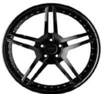
MEC Design meCCon Series, CCd5 Alu-Felgen, 3tlg. geschmiedet, Vorderachse 9,5Jx21 / Hinterachse 11Jx21, Farben/Finish nach Wunsch (Carbon Außenbetten mit Aufpreis); mögliche Reifen VA 255/35 ZR 21 sowie HA 295/30 ZR 21; Montagekit ist im Lieferumfang enthalten; bitte RDK berücksichtigen (nicht im Lieferumfang).
