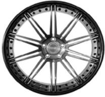
MEC Design meCCon Series, CCd10 Alu-Felgen, 3tlg. geschmiedet, Vorderachse 9,5Jx21 / Hinterachse 11Jx21, Farben/Finish nach Wunsch (Carbon Außenbetten mit Aufpreis); mögliche Reifen VA 255/35 ZR 21 sowie HA 295/30 ZR 21; Montagekit ist im Lieferumfang enthalten; bitte RDK berücksichtigen (nicht im Lieferumfang).
