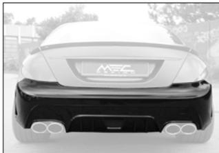
**MEC Design Heckstoßstange Extreme-Line,** nur in Verbindung mit MEC Design Auspuffanlage zu montieren, nur Fahrzeuge ohne AHK (Code550), komplettes Austausch-Teil, Montage an serienmäßigen Befestigungspunkten ohne Bohren, 216/BK-HSEx-H 1.649,00 €
