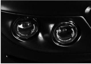
**Beleuchtungs-Set 2x2 LED-Technik für MEC Design Frontschürze;** bestehend aus 2x Blenden zur Aufnahme der Beleuchtungen, 2x LED-Nebelscheinwerfer (mit Abbieglicht-Funktion) und 2x LED-Tagfahrlichter incl. Kabelbaum (mit Einbauplan) 216/BK-B2x2LED-H 689,00 €
