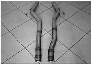
**MEC Design Vorschalldämpfer-Ersatzrohre für 63er + 65er AMG für W216 CL63+CL65AMG** (laute Version) Edelstahl, ab Kat, bestehend aus 2 Vorschalldämpfer-Ersatzrohren (VSD-ER), kein Gutachten/ nur Export, nur in Verbindung mit Artikel-Nr.: 221-216/AA-63ESD
