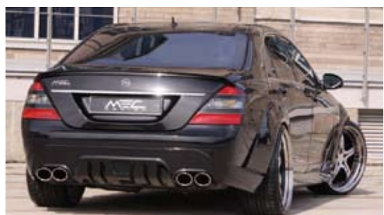
↑MECデザイン“ELS (Electronic Lowering System)ロウリングモジュール”でローダウンした足元に、3ピース鍛造モデルの“mecxtremell”をインストールし、コンプリートなボディフォルムを作った。ロウリングモジュールはエアマチックサス装着車のW221、S320、S500と、ABSサスペンション装着車のW221、S320、S65AMG他に対応する
