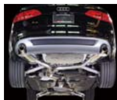
↑T304ステンレスを用いて製作したエクゾーストシステム。写真左は左右出し、右はクワッドタイプ。パイプの出し方、チップのフィニッシュに選択肢を設けている
