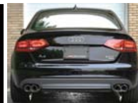
↑T304ステンレスを用いて製作したエクゾーストシステム。写真左は左右出し、右はクワッドタイプ。パイプの出し方、チップのフィニッシュに選択肢を設けている
