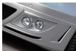
フロント用エキップメンツは、フォグとディヘッドライトを付属した純正バンパーの上から被せて装着するハーフタイプのスカートになる。ロアグリルインサートを設けてアグレッシブな表情を作った
