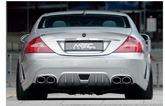
Côté châssis, MEC Design surbaisse le CLS d'environ 75 mm grâce à un module électronique. Le jeu de jantes est spécifique et surtout extrêmement large. En 11x20 à l'avant et en 12,5x20 à l'arrière et chaussées de pneus spéciaux en 285/25 et 325/25, le contact
